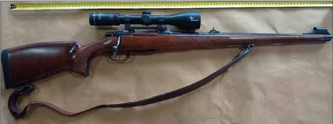
Arma de fuego portátil de hombro tipo Fusil de repetición - Marca: BRNO- Origen: Checoslovaquia (actual República Checa) - Modelo: 2-E- Calibre: .22 LR (Long Rifle)- Almacén: extraíble capacidad 5 cartuchos- Peso: vacío sin aparato de puntería: 2,9 Kg- Largo Cañón: 630 mm- Largo Total: 1085 mm- Disparador: regulable- Aparato de puntería- Marca: Redfield- Aumentos regulable: fijo 4X- Tubo diámetro: 1" plg.
