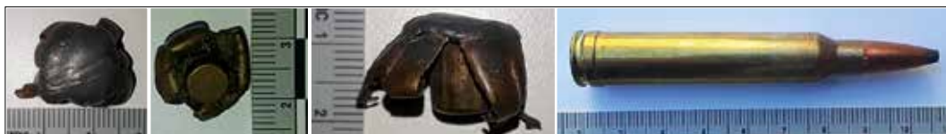
(01) Proyecto de caza (semienkamisado de núcleo expuesto) producto del disparo de un arma de fuego, extraído de un jabalí. Se observa al lateral derecho, cartucho calibre 300 Winchester Magnum.
